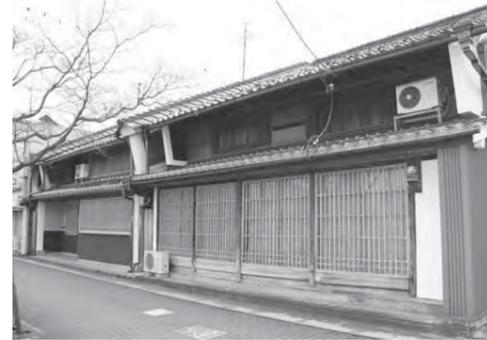
現在残る瓦に文化2年（1805年）の銘があることから、江戸末期の建造とされています。2階の軒高が低い「途子二階」と呼ばれる構造で、幅が狭くすっきりとした堅格子や、うだつ、袖壁が残っています。また、一般的な町屋二棟を一体化している点が特徴で、明治期の店舗形式の町屋としては珍しい造りになっています。
