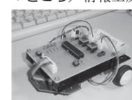
※内容／マイコンカー＝写真＝を製作し、走行コントロールなどをプログラミングする
