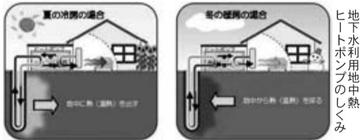
地下水利用地中熱ヒートポンプのしくみ
