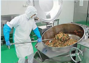
ゆでた食材を真空冷却機に入れた後、大きな釜であえ物を調理します。
