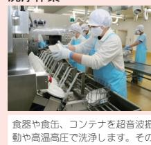
食器や食缶、コントainerを超音波振動や高温高圧で洗浄します。その後、専用の保管庫で加熱消毒を行います。
