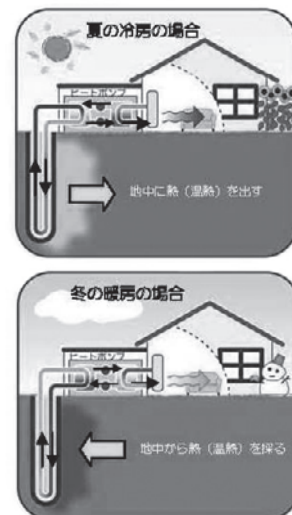
地下水中熱ヒートポンプのしくみ
