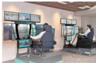
VRを使ってショベルの溶接作業をした後、正しく溶接ができているかどうか評価を行います。また、シミュレーターを使ってショベルを動かします。
