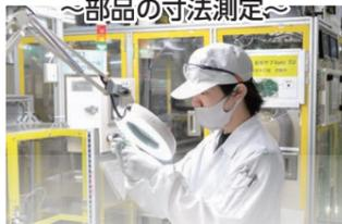
計測器の使い方を学んだ後、組み立て前の部品の寸法を測り、部品として問題がないか検査をします。
