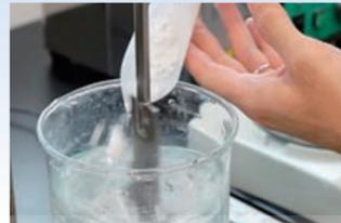
弱酸性の溶液と石灰を使用し、中和反応を行います。お客さまから注文された製品が、正しい特性かどうか、分析調査をします。
