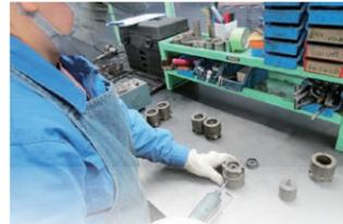
ピンを造る機械が正しく機能するように整備をします。機械で造られたピンが規格通りになっているかを検査し、これらの結果を精査します。
